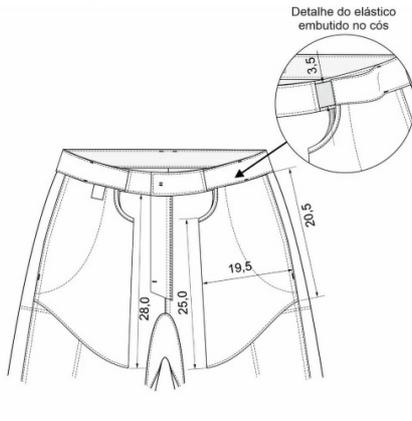
Figura 8 – Detalhes internos do dianteiro
