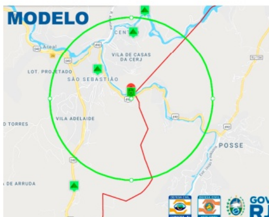
Pluviômetro com raio de 2km abrangendo 3 sirenes instaladas. Fonte: CEMADEN-RJ
