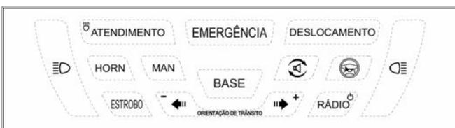
4.1.9.14.3. Características construtivas: O painel de controle deverá ter o tamanho de 1 din (179 x 50 mm) e o seu desenho e funções das teclas deve seguir o exposto abaixo, admitindo-se ajustes necessários devido a processos de fabricação, ajuste de moldes, pontos de fixação e afins.
