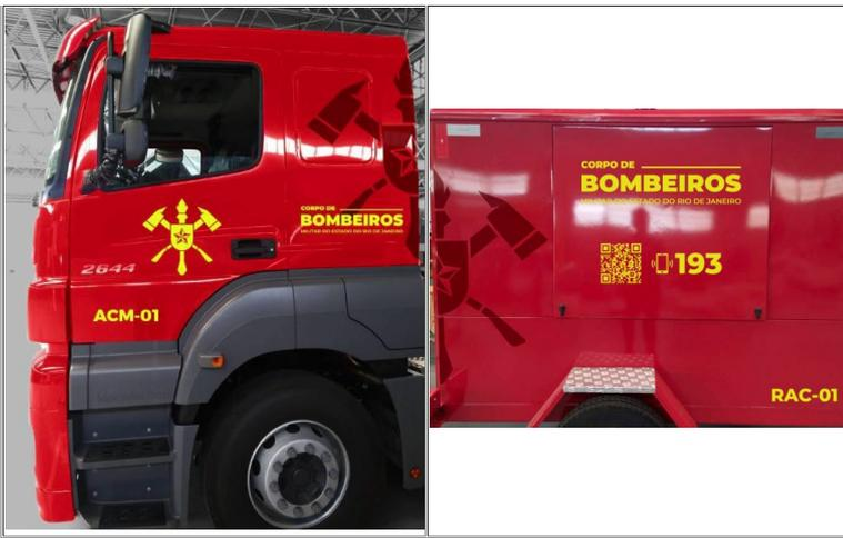
4.1.7.11. As partes traseiras dos carros devem ser preenchidas unicamente pelo parão zebraado com a fita refletiva; A malha deve ser recortada em áreas já existentes do próprio caminhão ou carro, como lanternas, olhos de gato, logos do tipo de carro (ex: 4x4) e marca do carro (ex: Scania), pegadores e afins.
