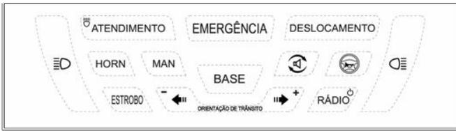
3.9.14.3. Características construtivas: O painel de controle deverá ter o tamanho de 1 din (179 x 50 mm) e o seu desenho e funções das teclas deve seguir o exposto abaixo, admitindo-se ajustes necessários devido a processos de fabricação, ajuste de moldes, pontos de fixação e afins.
