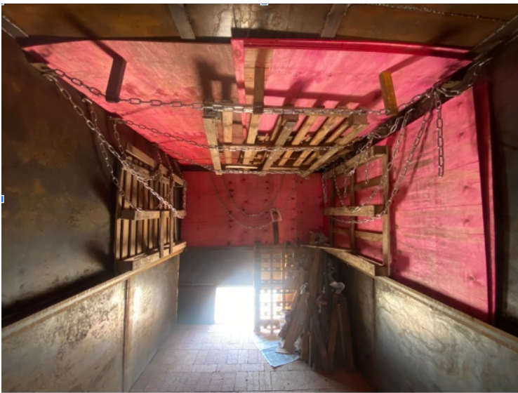
Figura 2- Foto da parte interna da Câmara de Combustão (CC) inferior do SDI 5 com foco montado e composto por folhas tipo madeirite, pallets, tábuas de madeira e papel jornal.
