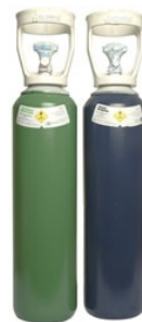
Figura 2: Identificação dos cilindros por cores, verde O 2 e azul N 2 O
